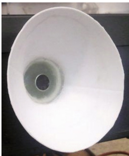
Fotografia 7. Wygląd mikrofonu zamontowanego w egzemplarzu modelowym
