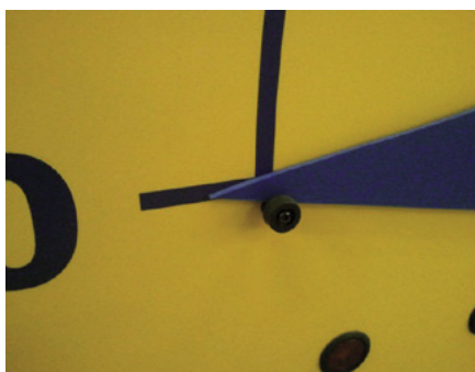
Fotografia 8. Wskazówka w położeniu spoczynkowym na odbojniku
